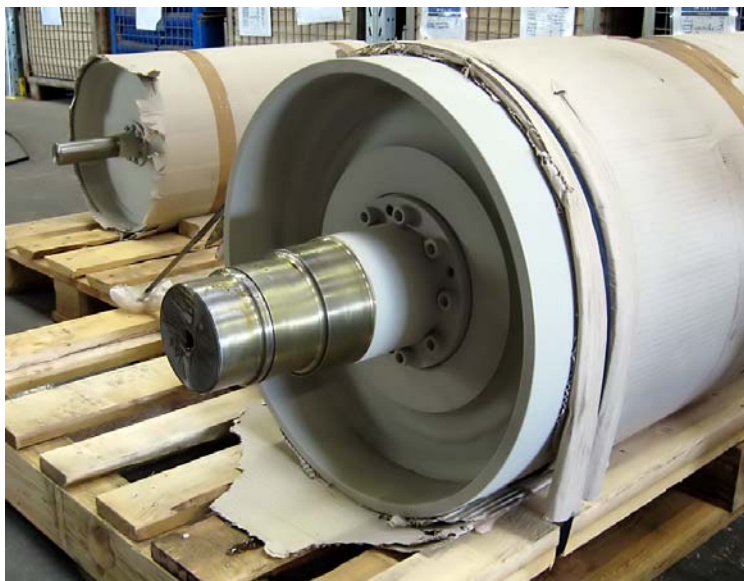
Aandrijtrommel \varnothing 500 x 1600, as bevestigd dmv klembussen \varnothing 140 mm (klaar voor verzending)
