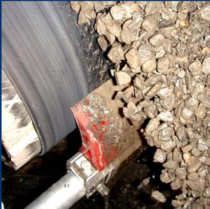
Der **Trommelabstreifer der Type TPH** ist aufgebaut aus mehreren Abstreifelementen aus Polyurethan mit besonders hoher Verschleißfestigkeit bei niedrigem Reibungswiderstand.
