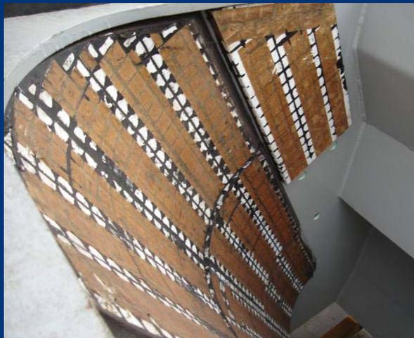
Les revêtements d'usure « Belle Liner » sont uniques sur le marché. Ils combinent la dureté de la céramique avec l'élasticité du caoutchouc pour offrir une solution très flexible aux problèmes d'abrasion et d'impact dans les goulottes.
