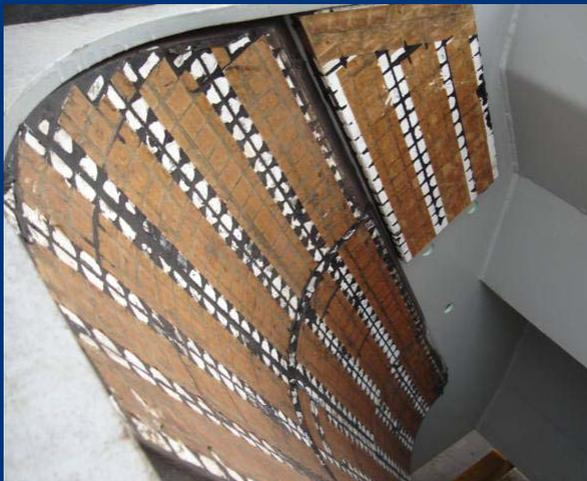
Unsere Verschleißplatten "Belle Liner" sind einzigartig. Die Verschleißfestigkeit von Keramik wird kombiniert mit der Elastizität von Gummi und bietet somit eine dauerhafte und flexible Lösung gegen Verschleiß- und Durchschlagprobleme in Auf- und Übergabe-Trichtern und Schurren.
