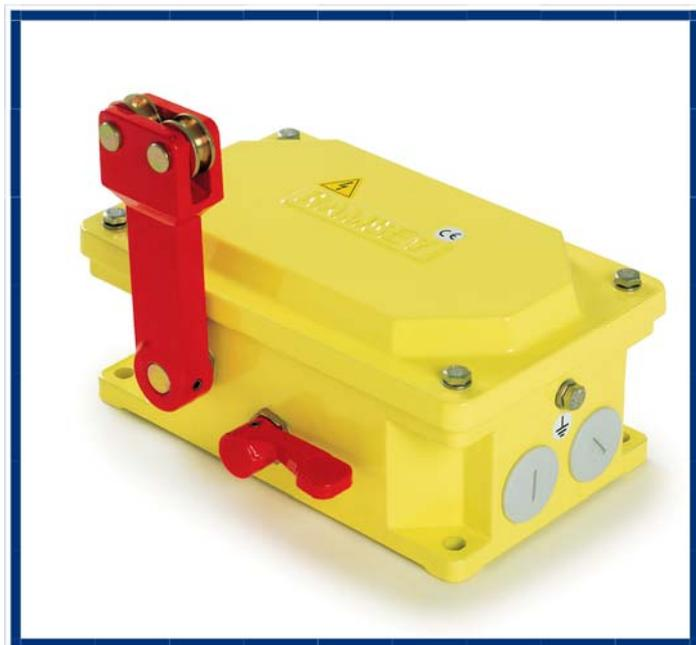
L'appareil est équipé de deux micro-contacts qui déclenchent quand le levier est incliné à plus de 18°.
