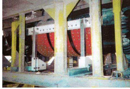
Basalt, 1000 T/uur. Transportband 1000 mm (diepe trog)
