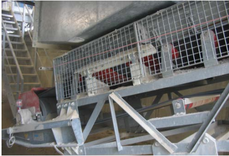
Kalksteen, 300 T/uur. Transportband 800 mm
