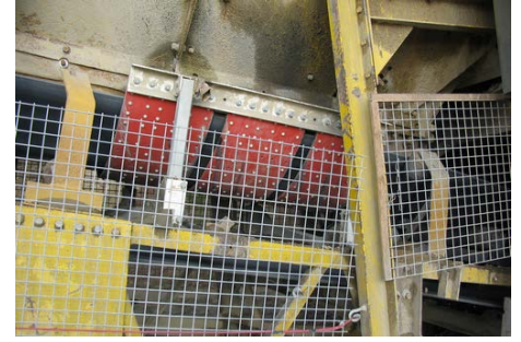
Cement, 600 T/uur. Transportband 1000 mm
