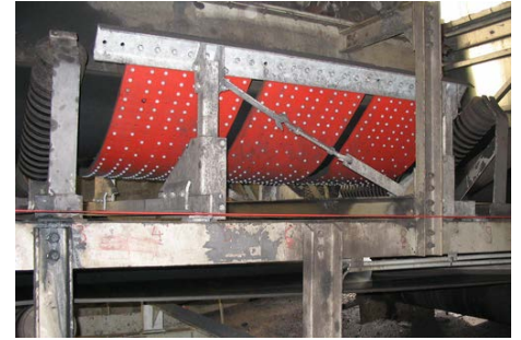
Kolen, 3200 T/uur. Transportband 1600 mm, 3,2 m/sec
