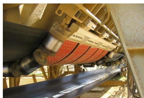
Cimenterie, 800 T/heure. Bande 1200 (5 sangles suspendues)
