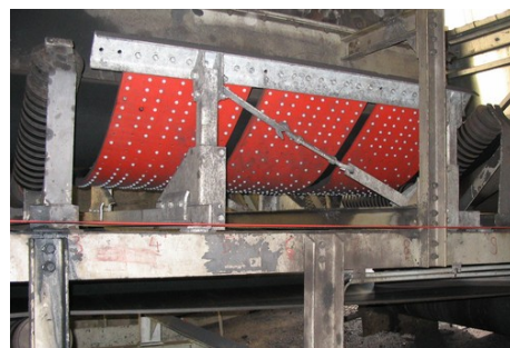
Port charbonnier, 3200 T/heure. Bande 1600, vitesse 3,2 m/sec
