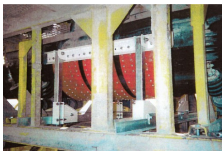
Basalte, 1000 T/heure. Bande 1000 (auge profonde)
