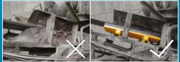
Ein Transportband, das durch Tragrollen unterstützt wird, bildet zwischen den Rollen nach unten geneigte Wölbungen. Diese Wölbungen führen bei der Übergabe, zu Materialverlusten und Staubentwicklung. Unsere BLU-TEC Aufpralldämpfer gleichen nicht nur diese Wölbungen aus, sondern verhindern auch effektiv Beschädigungen am Fördergurt.
