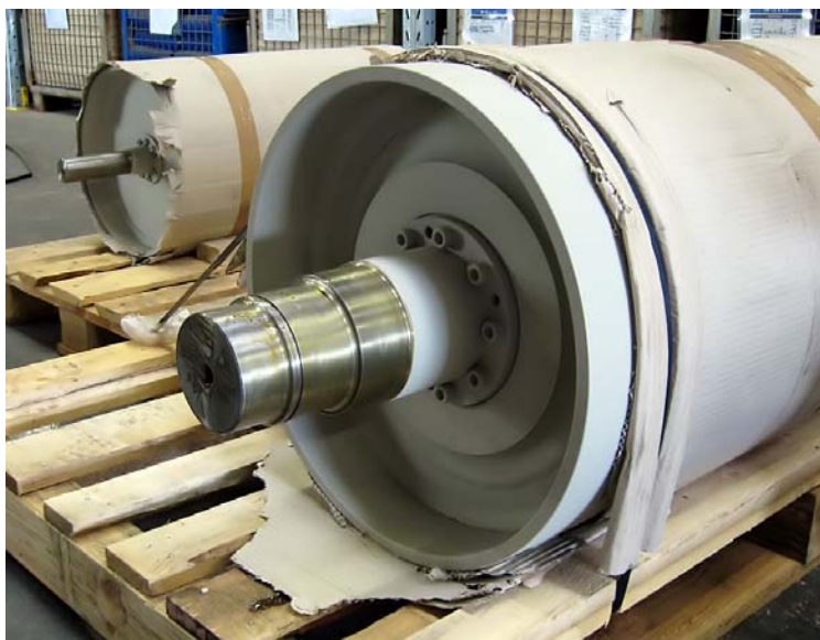
Tambour de commande \varnothing 500 x 1600 avec arbre fretté \varnothing 140 mm (prêt pour expédition)
