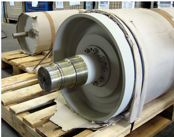
Aandrijftrommel Ø 500 x 1600, as bevestigd dmv klembussen Ø 140 mm (klaar voor verzending)
