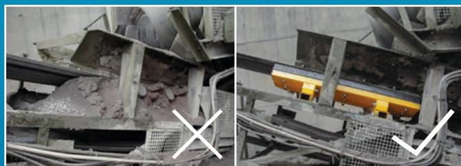
Une bande transporteuse en charge, supportée par des batteries à rouleaux classiques s'infléchit inévitablement entre celles-ci, provoquant un manque d'étanchéité et des pertes de matière. Un impact important de produits coupants peut également endommager la courroie en caoutchouc car les rouleaux ne sont pas flexibles et mener à un remplacement prématuré de celle-ci.
