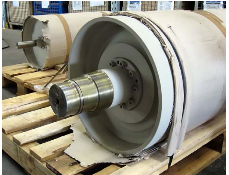
Tambour de commande Ø 500 x 1600 avec arbre fretté Ø 140 mm (prêt pour expédition)
